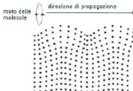
**Propagazione di un'onda detta di Rayleigh con moto molecolare ellittico (esempio elementare di onda sismica)**
